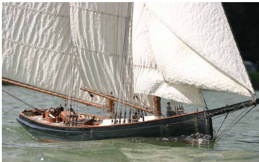
boven: Zeilend scheepsmodel van de loodsschoener Hesper , lengte 1,81 m (1:24), gebouwd door Klaus Prystaz. (Foto: Hans Staal)
